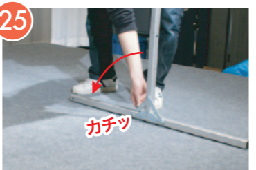
20 付属のネジで、フレームと脚を固定。
