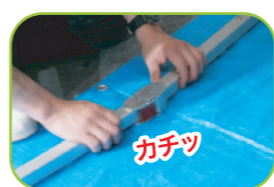
ジョイント部分は全てカチッと音がするまで伸ばし固定する。
